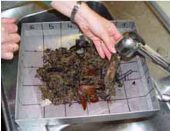
Abbildung 47: Abwaschen von Ästen oder Blättern vor Entnahme der Unterprobe
