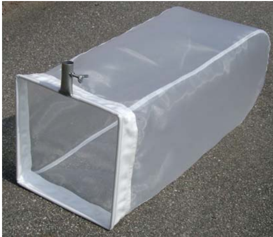
Abbildung 37: Benthoskescher nach AQEM/STAR (Foto: Hydro-Bios GmbH, verändert)
