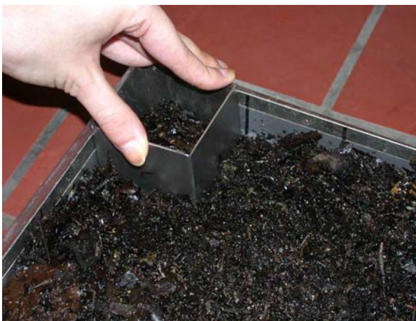
Abbildung 49: Entnahme der Unterprobe
