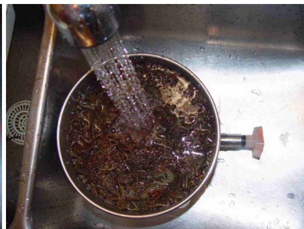
Abbildung 52: Abtrennen der Grobfraction (mit Hilfe der Siebkaskade)
