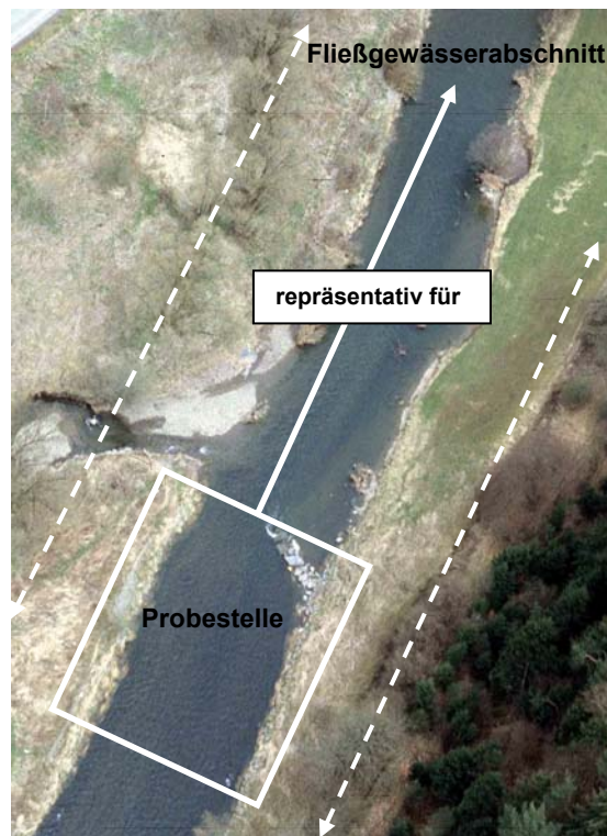
Abbildung 1: Schematische Darstellung der Probestelle und des zu untersuchenden Fließgewässerabschnitts/Wasserkörpers (unmaßstäblich) Foto: S. Jähnig
