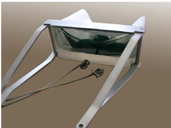
Abbildung 38: Dredge (Foto: Hydro-Bios GmbH, verändert)
