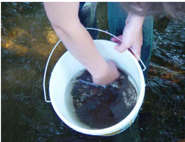
Abbildung 40: Schlammtechnik: Das Probenmaterial wird mit der Hand vorsichtig in Rotation versetzt.
