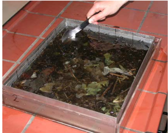
Abbildung 48: Gleichmäßiges Verteilen des Probenmaterials auf dem Unterproben-Sieb
