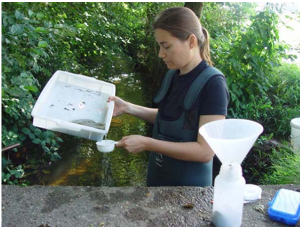
Abbildung 44: Überführen des Probenmaterials in weithalsige Kautex-Flaschen. Restliches Wasser wird durch ein Handsieb (Maschenweite 500 \mu\text{m} ) abgossen.
